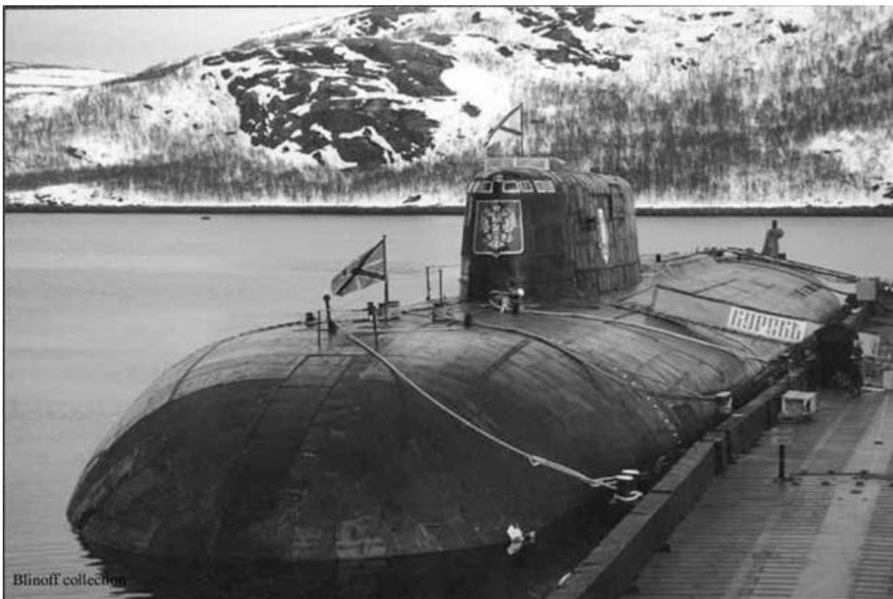
АПРК – 141 «Курск» проекта 949А спущен на воду 16 мая 1994 года. Подводная скорость – 33 узла, надводная – 15; рабочая глубина погружения – 420 м. Экипаж – 130 человек. Водоизмещение надводное – 14.700 т, подводное – 23.860 т. Длина – 154 м, ширина – 18, 2 м. Средняя осадка – 9,2 м. За схожесть конфигурации корпуса в надводном положении с известным хлебобулочным изделием окрещен "батонном".
